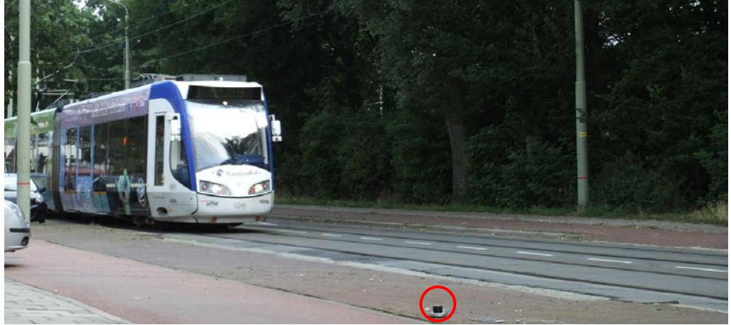
Figuur 1 - Tram passeert trillingsensor op de Aaltje Noorderwierstraat
