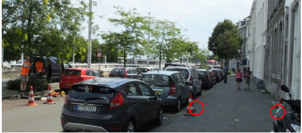
Figuur 15 – Kunstmatige trillingsbron op de plaats van de tram voor de woning aan de Van Hasselkade 12 voor de overdrachtsbepaling
